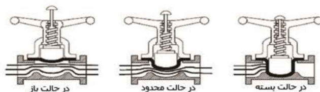
شیر دیافراگمی در حالت بسته، محدود کننده و باز
